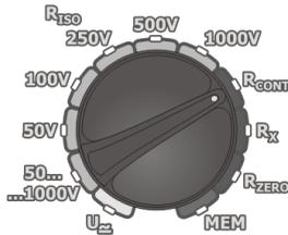
Drehschalter zur Funktionswahl auf  $R_{\text{CONT}}$  stellen.
