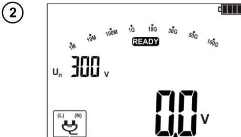
Nachdem WS-04 / WS-11 über die Buchse angeschlossen wurde, erscheint auf dem Display ein Mnemonik, der die Erkennung des Adapters signalisiert.
