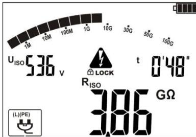
Das Gerät führt Resistenzmessungen der Isolierungen für die Kabelpaare in der folgenden Reihenfolge durch: L-N, L-PE, N-PE.
