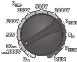
Der Drehschalter zur Funktionsauswahl sollte auf einer der Positionen eingestellt werden  $R_{ISO}$ , mit gleichzeitiger Auswahl der Messspannung (**MIC-30** Position **50...1000V** alle 10V in em Bereich gewählt). Das Messgerät befindet sich im Modus zur Spannungsmessung.
